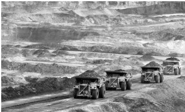
Figura 21.4: Imagen de uno de los sitios donde se extrae Arenas Bituminosas en Alberta Canadá. Las arenas bituminosas, han de tratarse en instalaciones que aporten altas temperaturas para producir un combustible con la viscosidad del chapopote, el cual al ser disuelto con benceno puede bombearse por tuberías siendo un fluido muy viscoso e inestable. Tomada de http://www.agoracosmopolitan.com/news/ufo_extraterrestrial/2012/11/03/4741.html
